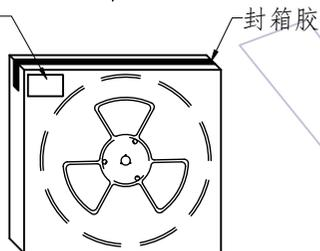
NO4: 将卷盘套PE-32防水袋, 放一包干燥剂后, 真空机封口, 放入内箱, 用封箱胶封装好, 并贴上标签, (1卷盘/内箱, 550PCS/内箱)
